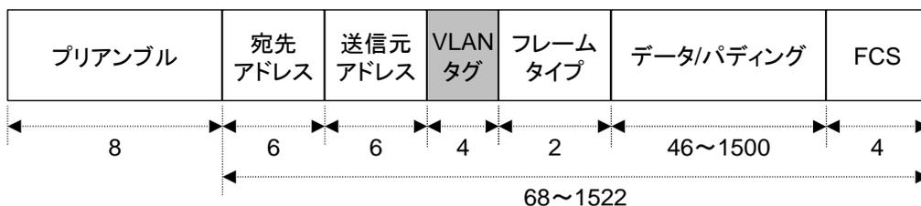
図 5-8 IEEE802.1Q 準拠の VLAN タグ付きフレームの構造
